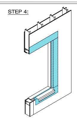
INSTALL METAL FLASHING AT SILL
